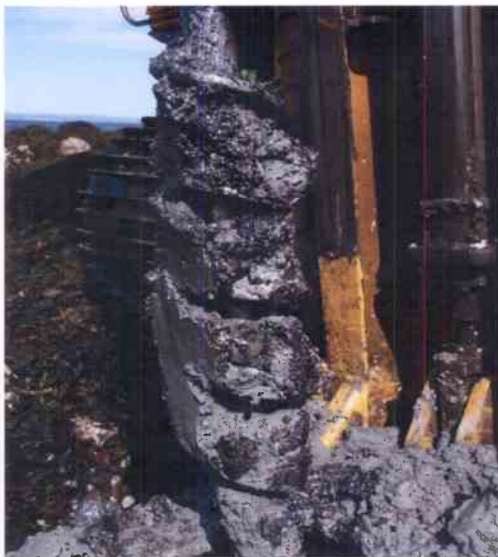
Figur 9 Prøvepunkt MC32. Frifase kreosot i gruslaget på toppen. Underliggende masser av siltig sand, med markert kreosotlukt.
